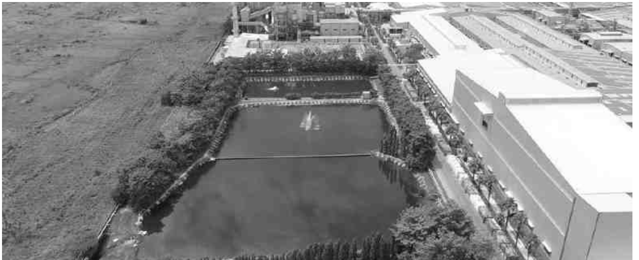
படம் 10-3 மழை நீர் சேகரிப்பு குளம் மற்றும் ரீசார்ஜ் குழிகளைக் காட்டும் தளவமைப்பு
