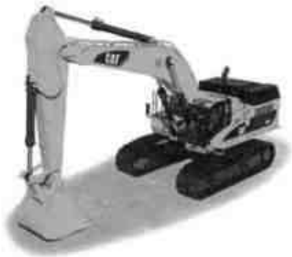
Fig .7a): Hydraulic Excavator
