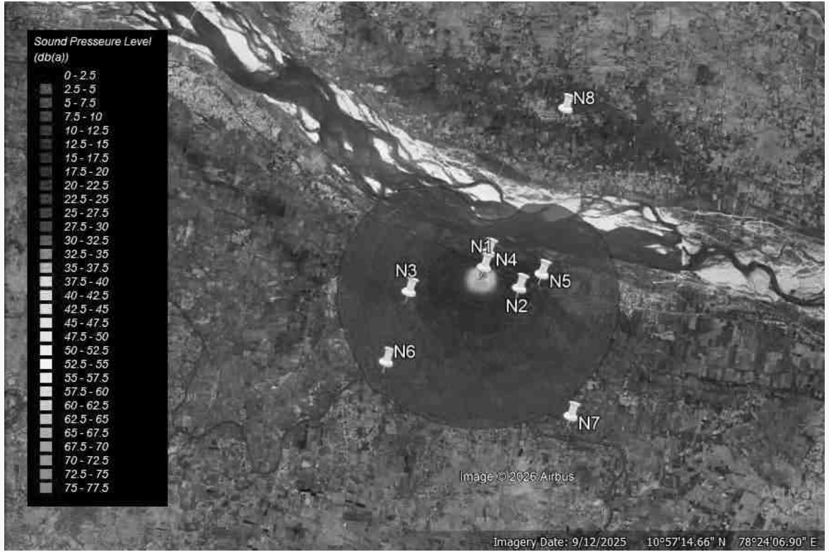
படம் 4.8 தடுப்புச் சுவர் இல்லாத நிலையில், செயல்பாட்டுக் கட்டத்தின்போது இரைச்சல் அளவுகளைக் காட்டும் சம-அளவுக்கோடுகள் (Isopleths)
