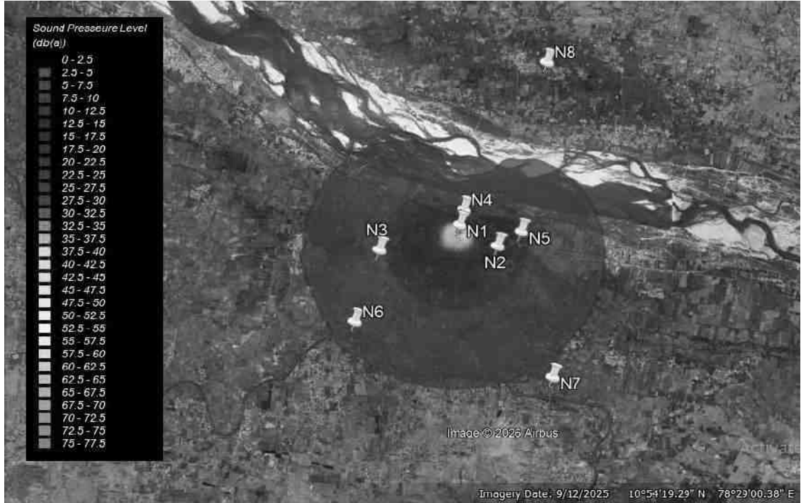
படம் 4.8 தடுப்புச் சுவர் இல்லாத நிலையில், செயல்பாட்டுக் கட்டத்தின்போது இரைச்சல் அளவுகளைக் காட்டும் சம-அளவுக்கோடுகள் (Isopleths)
