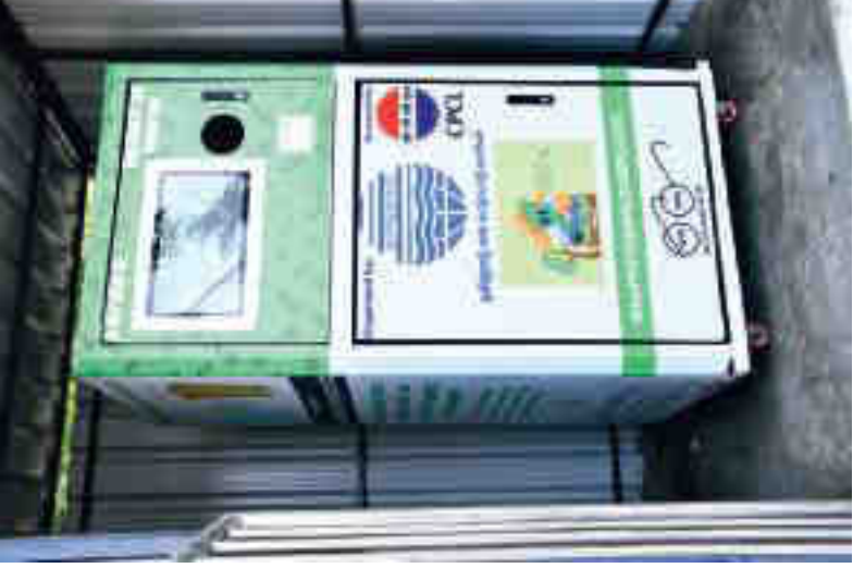
செயல்படுத்தப்பட்ட பிளாஸ்டிக் பாட்டில்களை மறுசுழற்சி செய்வதற்கான சேகரிக்கும் இயந்திரம்
